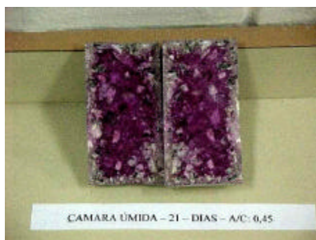
Figura 5 – Exemplos de corpos-de-prova dos concretos com diferentes valores de a/c submetidos aos diversos ciclos de cura, tratados com solução de fenolftaleína para evidenciar a espessura de carbonatação acelerada
