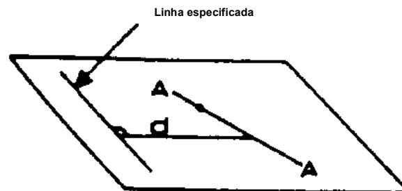
FIGURA 3.5 Alinhamento lateral, representando a medição a distância "d" entre o alinhamento padrão/global e o alinhamento a ser verificado, linha AA (ACI 117R-90).
