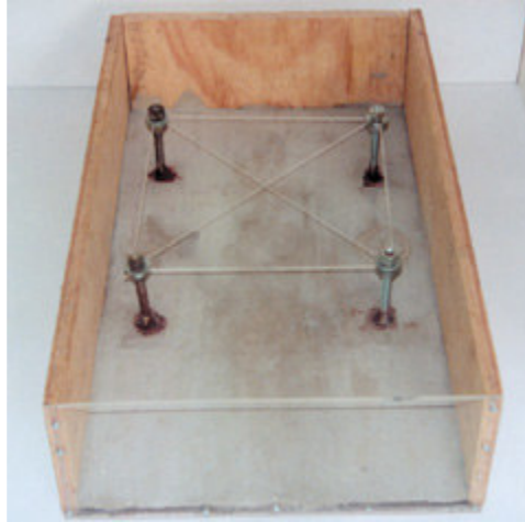
(1) Fixação dos chumbadores com resina de ancoragem adequada
